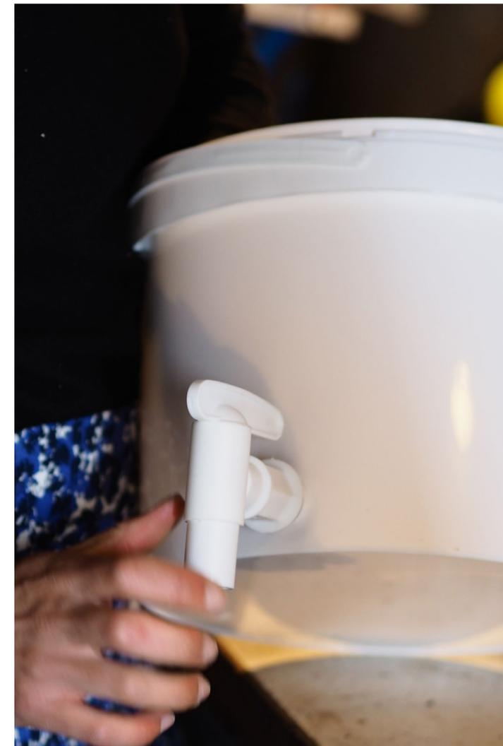
Mise en place du robinet sur le bac réceptacle
