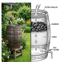
Méthode Traditionnelle pour Filtrer l'Eau de Pluie en Tonneau
